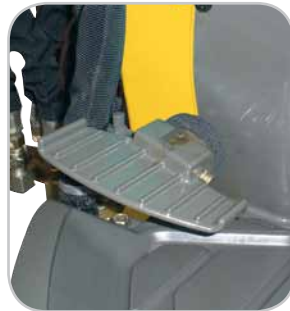
Pédales rétractables (Pédale PTO et pédale d'orientation de la flèche)
